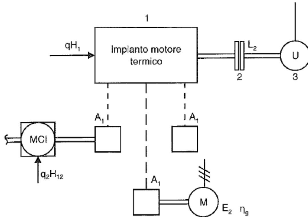
1. motore; 2, flangia d'accoppiamento; 3, utilizzatore;  $A_1$ , ausiliari
