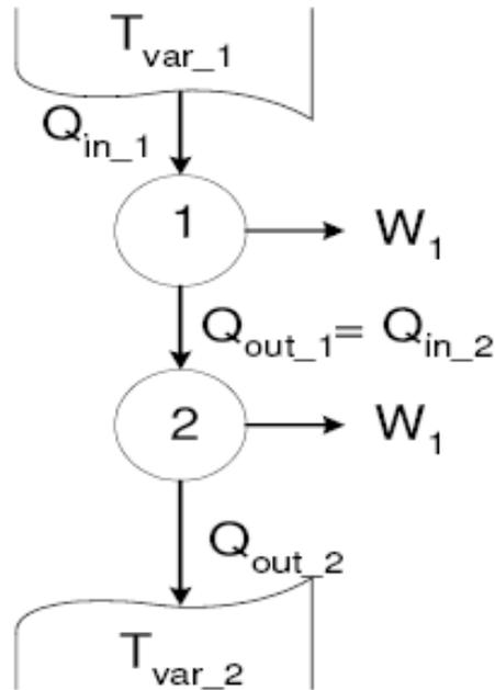
La figura rappresenta il caso elementare di due cicli od impianti disposti termicamente in serie
